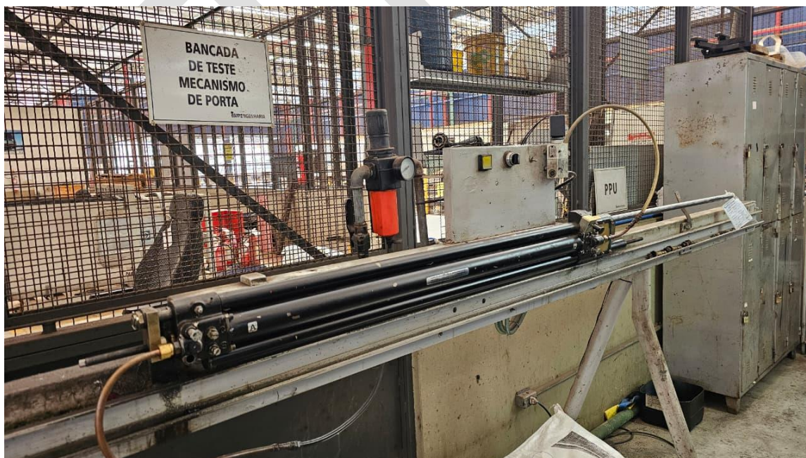
Figura 6 - Bancada de Teste de Porta.
